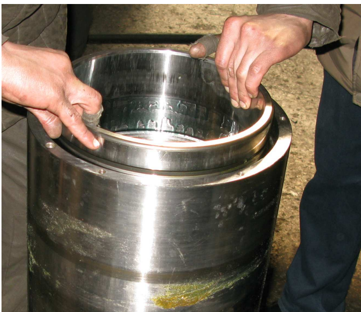
Установка внешней обоймы подшипника
