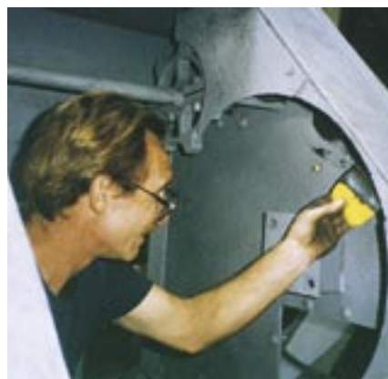
Пластичная Сталь являлась первым, металлонаполненным эпоксидным компаундом для ремонта. До сих пор она применяется для эффективного ремонта и восстановления многих металлов.
