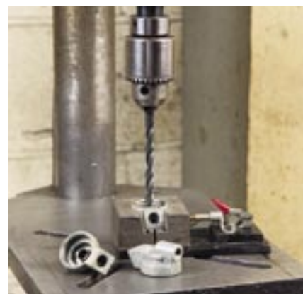
Жидкая пластичная сталь позволяет быстро и экономично изготовить зажимные механизмы.
