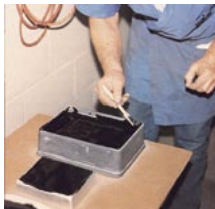
Flexane® 80 жидкость используется для производства шаблонов литья, восстанавливает сложные детали.
