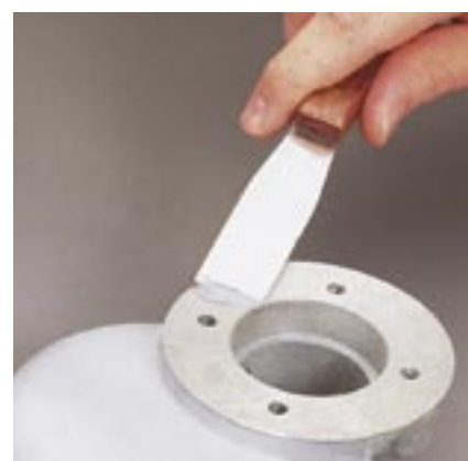
Шпаклевка с алюминиевым наполнителем используется для ремонта или восстановления алюминиевых литьевых деталей.
