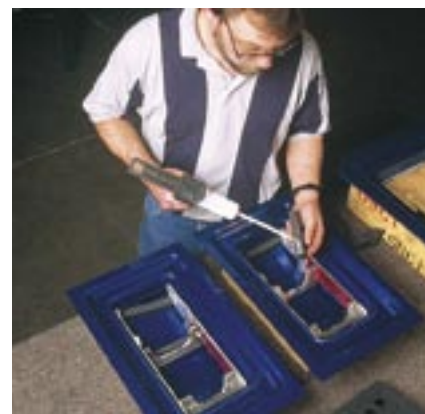
Эпоксидный гель – 1 минута – адгезив супер быстрого отверждения, который не прогибается и не скользит по вертикальным или перевернутым поверхностям и исключает необходимость фиксации частей.
