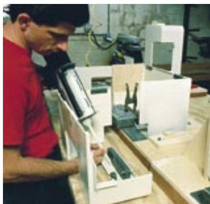
2 Top прозрачный эпоксид обеспечивает крепкое безусадочное склеивание металлов и заполняет зазоры между плохо состыкованными поверхностями.
