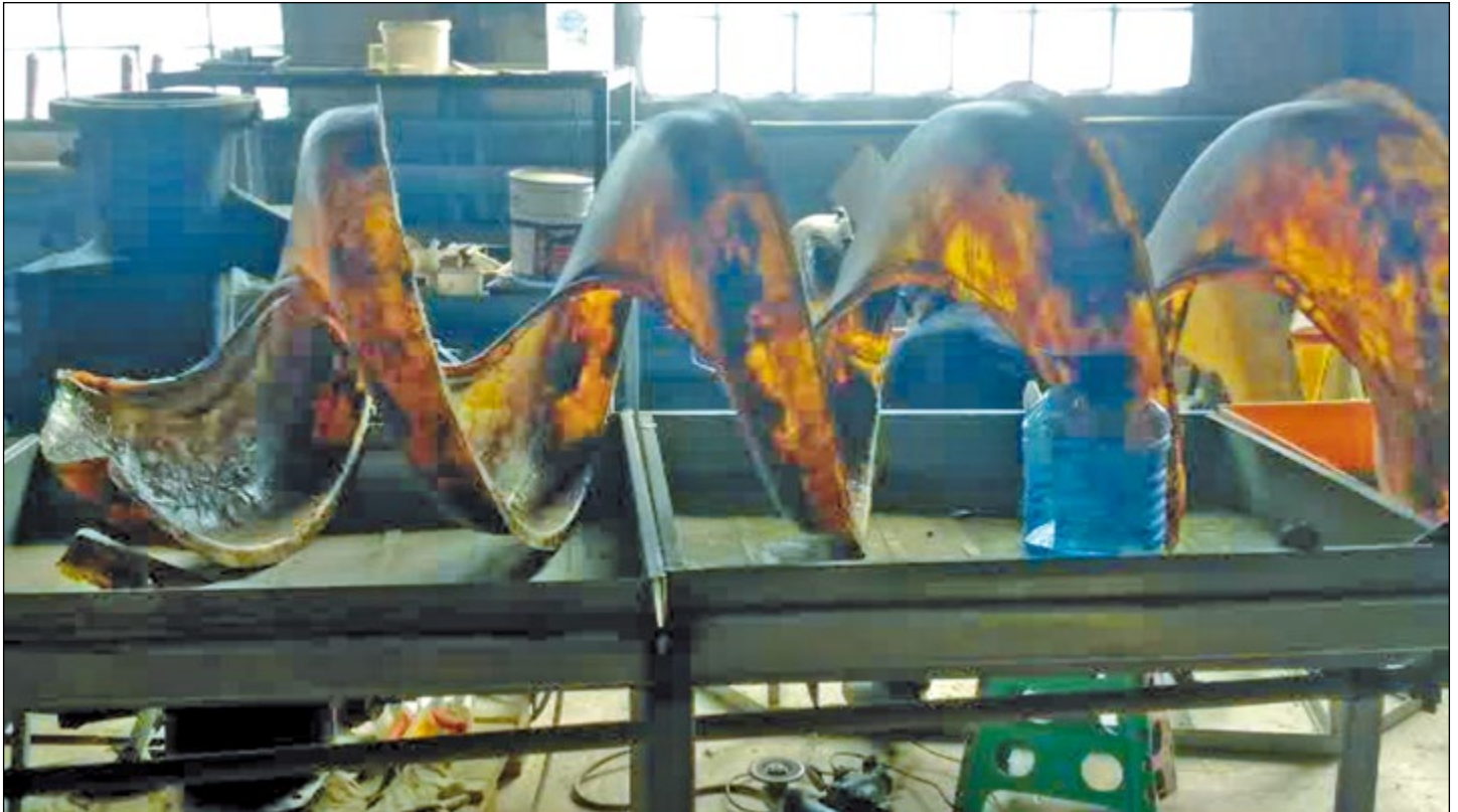
Фото № 7. Форма-крышка после отделения от конструкции лотка.
