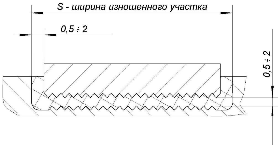
Рис. 5 Схема расположения разрезной втулки в проточке.
